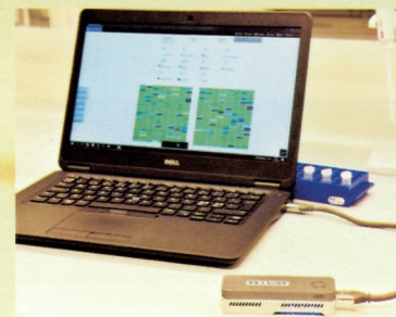
Mynd 6. MinION er ein nýggj sekvenserings-maskina, sum er á stödd við eina farteleson og kann koplast til eina teldu við einum USB-stikki. Ætlanin var at nýta hana at avlesa silvurkyktaarvamassan, men tíverri gekk ikki sum ætlað.
