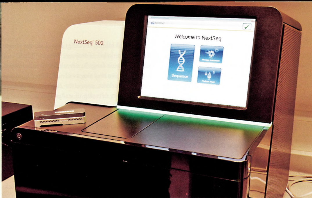
Mynd 5. Her síggjast báðar sekvenseringsmaskinurnar, sum skuldu nýtast til at avlesa silvurkyktaarvamassan. MinION er nógv minni enn aðrar sekvenseringsmaskinur – eitt nú NextSeq 500, sum hon her stendur omaná.
